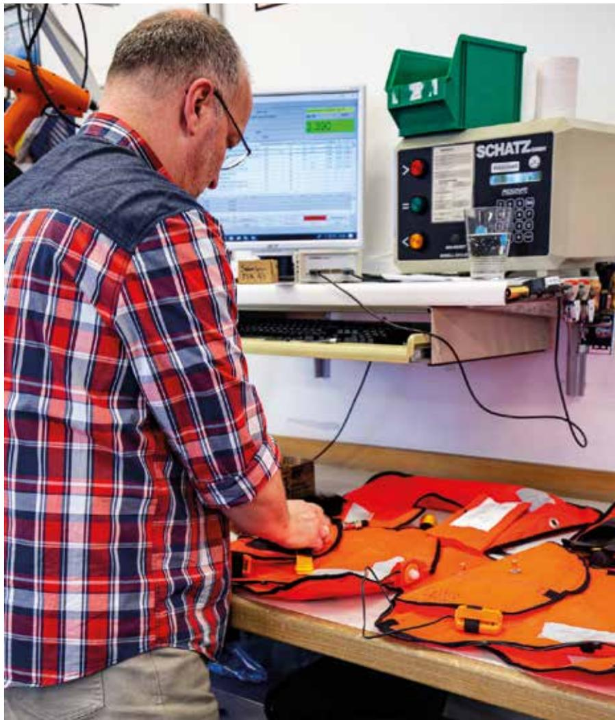
Kontrolle ist alles: Bereits während der Produktion werden Komponenten und Arbeitsschritte überwacht. Jede CO<sub>2</sub>-Patrone, die später einmal die Weste im Bedarfsfall aufblasen soll, wird gewogen und auf Unversehrtheit geprüft. Gleiches gilt für Auslöse-Tabletten und -Vorrichtungen. (Fotos: Secumar)
