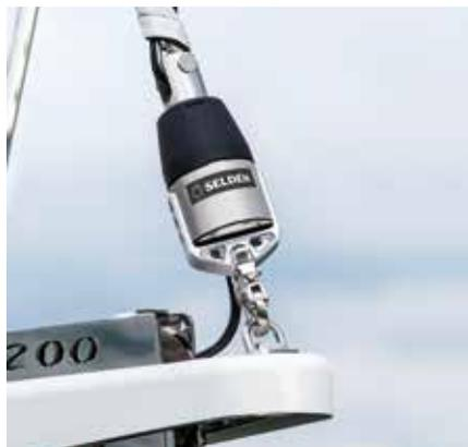
**Seldén**, schwedischer Hersteller von Riggs und Rollrefanlagen, hat eine elektrische Rollrefanlage („Furler“) für Code-0-Vorsegel vorgestellt. Der **CXe45-Furler** rollt das riesige Vorsegel in zehn Sekunden weg, auch wenn es schon flattert. Die Anlage kann unter Deck, an Deck oder auch an einem Bugspriet installiert werden. Die maximale Last beträgt 4,5 Tonnen. Bedient wird der Roller auf Knopfdruck – und nicht mehr mit einer störanfälligen Rollleine. <https://support.seldenmast.com/>
