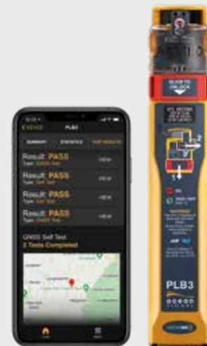
der RescueME PLB3 AIS Personal Locator Beacon von Ocean Signal der Gewinner (Foto). Das Gerät vereint einen EPIRB-Notsignalsender mit einem AIS-Sender. So kann nicht nur über Satellit ein Notsignal abgesetzt werden. Das Gerät sendet auch seinen Standort an andere Schiffe in der Nähe, was im Notfall die Suche erheblich beschleunigen kann. Die METSTRADE findet 2023 vom 15. bis 17. November statt. [www.metstrade.com](http://www.metstrade.com)
