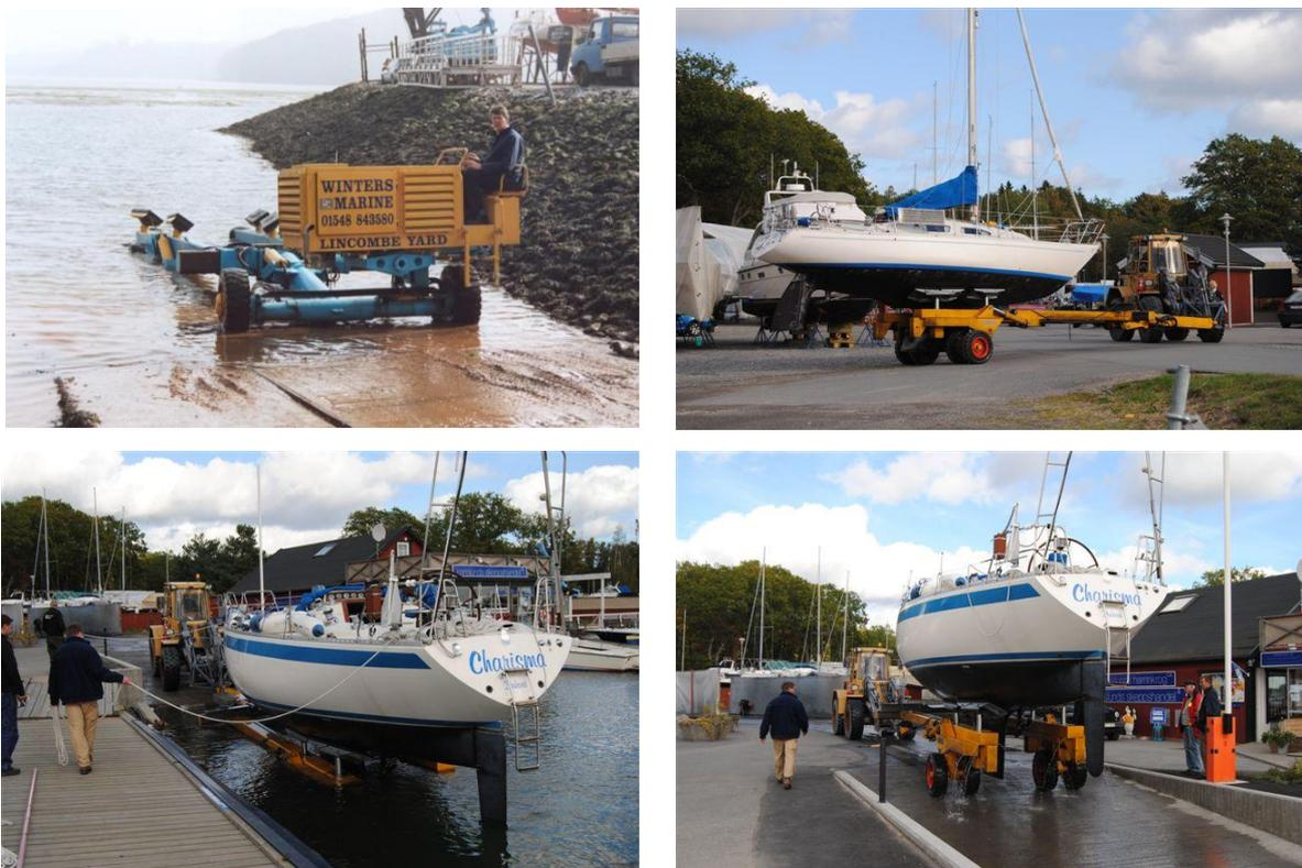
Abb. 13: Demonstration eines Dockingsystems ohne und mit Zugmaschine (Traktor) (Quelle: Elephant Project GmbH).
